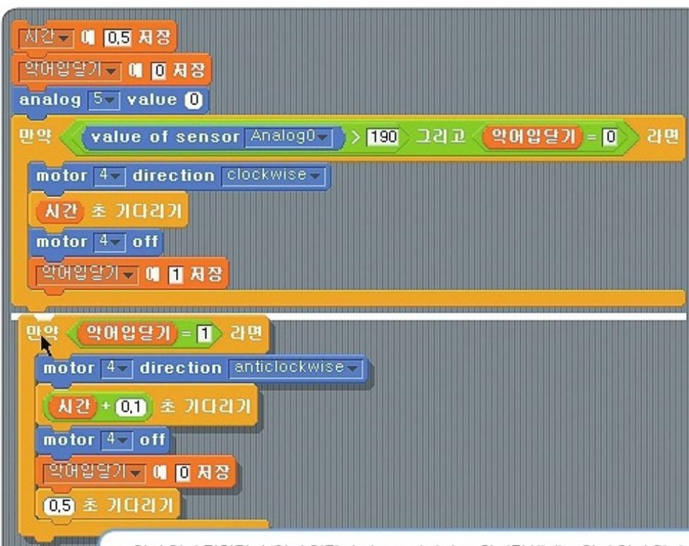
7. 악어 입이 닫히면서 '악어 입닫기'가 1로 바뀌어요. 하지만 반대로 악어 입이 열리게 되면 변수 값이 0으로 바뀌게 되어요. 만약 입이 닫히면서 입닫기 값이 1이 되었다면 모터가 반대로 돌게되고 입이 열리게 되요. 그러면 다시 '악어 입닫기' 값이 0로 바뀌게 되요~! 그림은 앞 과정과 같은 방법으로 실행되니 그림을 보면서 차근차근 따라해보세요. 이제 이정도는 여러분이 스스로 할 수 있죠?
